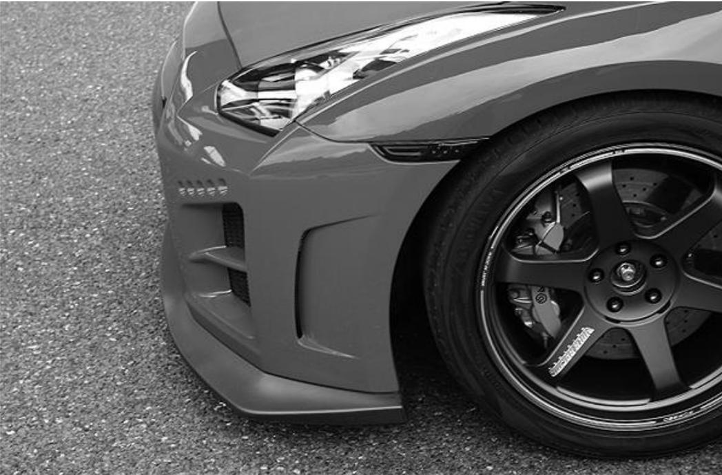
ラジエターカバーを純正のクリップを使用して取付けて下さい。(8箇所)
