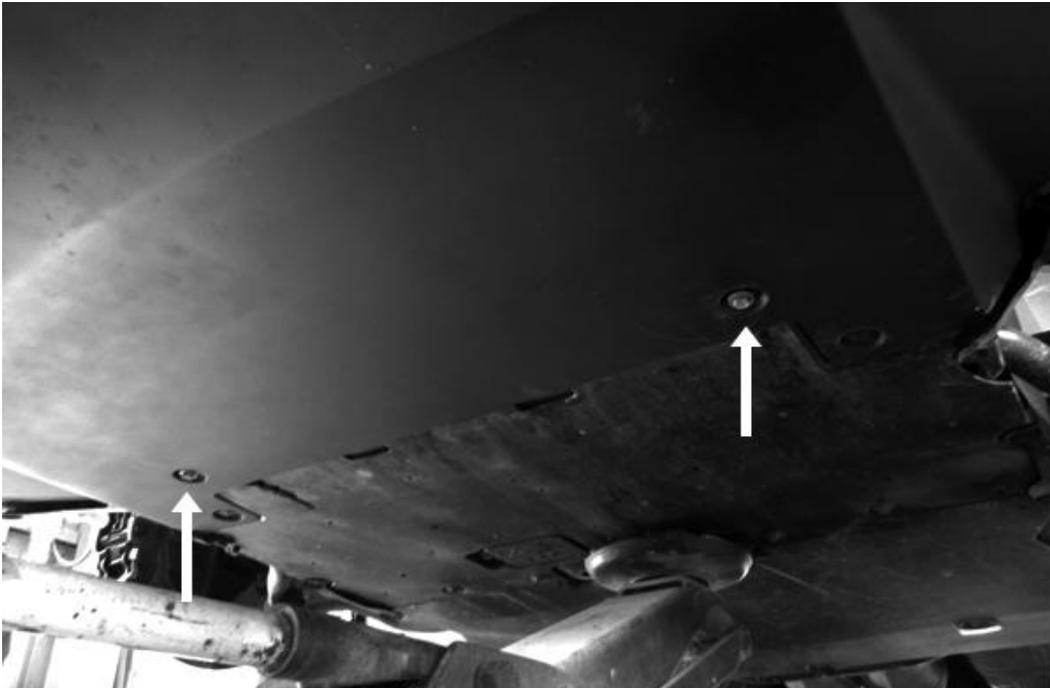
アンダーディフューザーサイド後部は純正のホイールインナーカバーに純正のクリップを使用して固定します。(片側5箇所、左右 計10箇所)写真は車両左下側の写真です。
