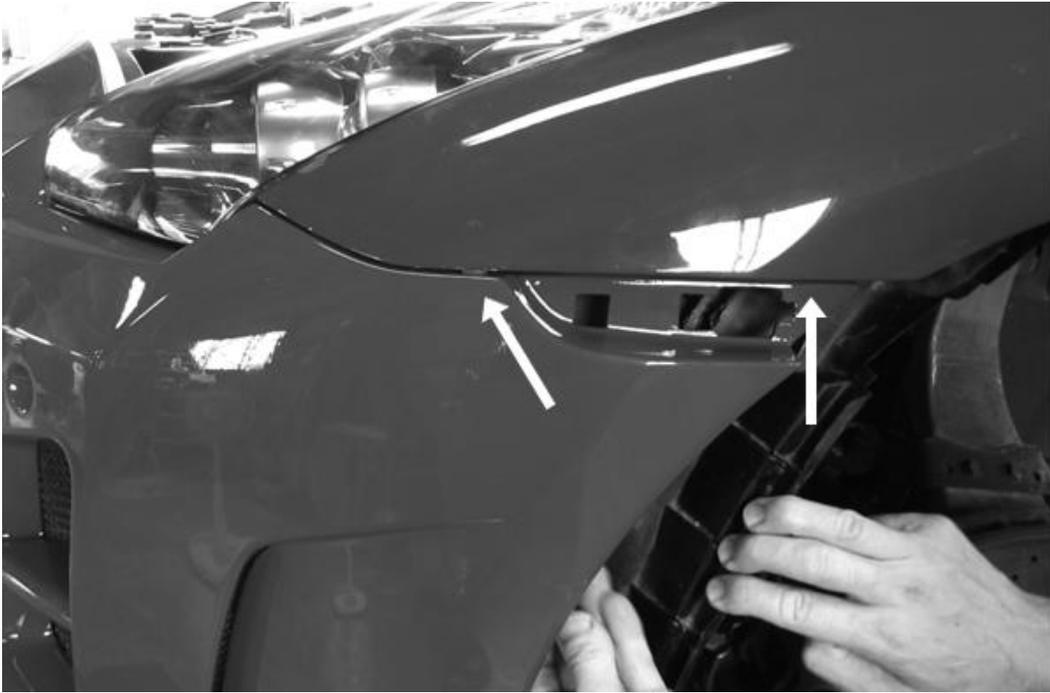
アンダーディフューザー中央後部は純正ボルトでを使用して固定します。(2箇所)
