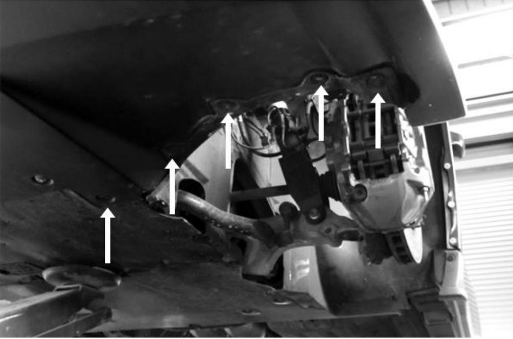
バンパーが完全に固定されましたらサイドウインカーをバンパーに取付けて下さい。
